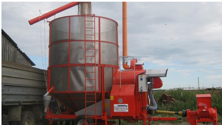
Мобильные зерносушилки пользуются наибольшей популярностью у потребителей. В отличие от шахтных, стационарных, карусельных зерносушилок, они удобны в использовании и менее затратны, т.к. не требуют дополнительных строительных работ, разработок проектов и смет, получения множества согласований.
