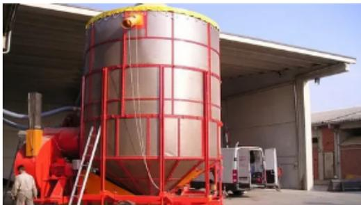
Компания Fratelli Pedrotti представляет лучший в Европе модельный ряд зерносушилок циклического типа. Мобильные зерносушилки Фрателли сочетают в себе невысокую стоимость и высокую производительность сушки зерновых и зернобобовых культур. Одному циклу соответствует четырехфазный процесс: загрузка, сушка, охлаждение, выгрузка
